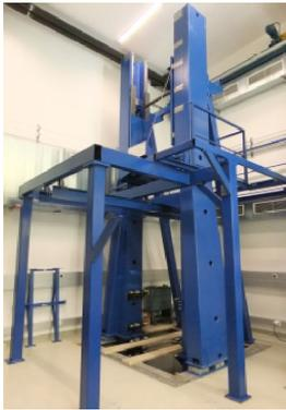
Abb. 2: Stahlrahmen der 250 kN Totlastanlage. Um Steifigkeit und Stabilität der Schweißkonstruktion zu erhöhen, wurde sie mit Betonfüllungen ergänzt.
