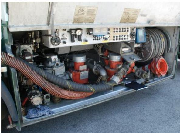
Messanlage an einem Tankwagen
