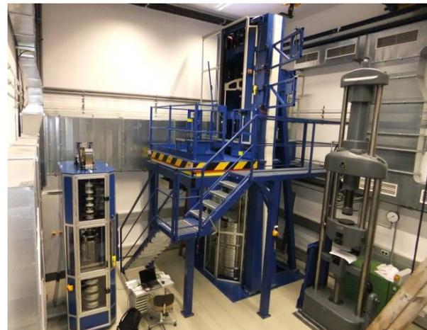
Abb. 8: Realisation der Systeme: Links kN 2, Mitte 250 kN Totlastmaschine mit der verbundenen 1MN hydraulischen Maschine rechts. Auf der 250 kN Totlastmaschine gibt es zur besseren und sicheren Bedienbarkeit eine Hub-Arbeitsbühne für den Betreiber. Diese Anlage hat eine Gesamthöhe von 9 m und wiegt gesamt etwa 50 t.
